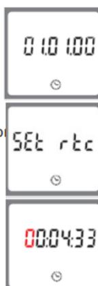
Appuyer sur le bouton «Défilement» pour changer l'option. Une fois la nouvelle valeur sélectionnée, appuyer sur le bouton «Entrer» pour confirmer.
