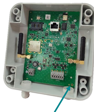
Dévisser les vis pour détacher le PCB du boîtier
